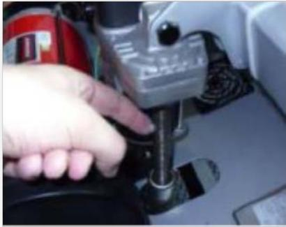
4) Очистите и смажьте консистентной смазкой PTFE штифтовое соединение подъемного двигателя и подъемной стойки с обеих сторон.
