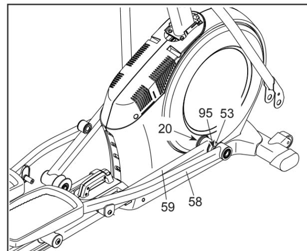
См. СБОРОЧНЫЙ ЧЕРТЕЖ С на стр. 31. Найдите левый и правый экраны (73, 74). Удалите винты M4 x 25мм (124), винты M4 x 19мм (5) и винты M4 x 48мм (107) с левого и правого экранов. Затем снимите правый экран.
