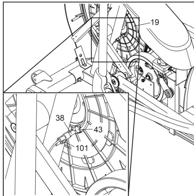
Затем ослабьте указанный винт М4 х 16 мм (101). Немного переместите геркон (38) от или к магниту (43), а затем затяните винт. Затем, подключите адаптер, и качните шкив (19) вперед и назад так, чтобы магнит проходил геркон неоднократно. Повторяйте эти действия до тех пор, пока консоль не начнет показывать корректные данные.
